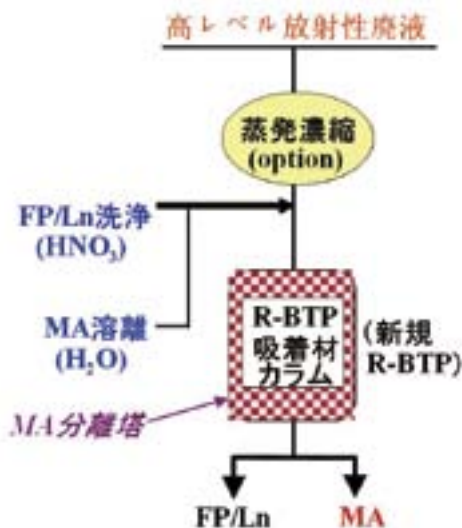
図1 簡素化MA分離プロセス概念
