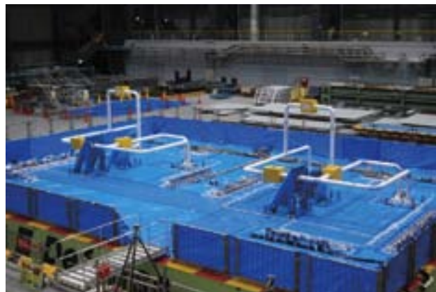
図1 平成22年度に実施したE-ディフェンス実験の様子 左側が減肉のない健全な試験体、右側が減肉のある試験体。右側は、エルボ4ヶ所とティ1ヶ所に、50%程度の全周減肉を模擬しています。
