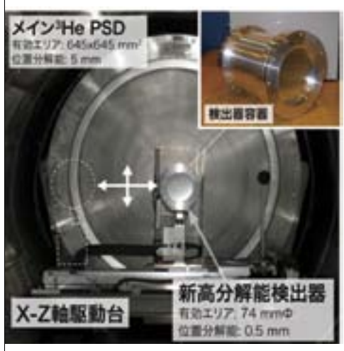
図2. SANS-U に設置された新高分解能検出器とその駆動系
