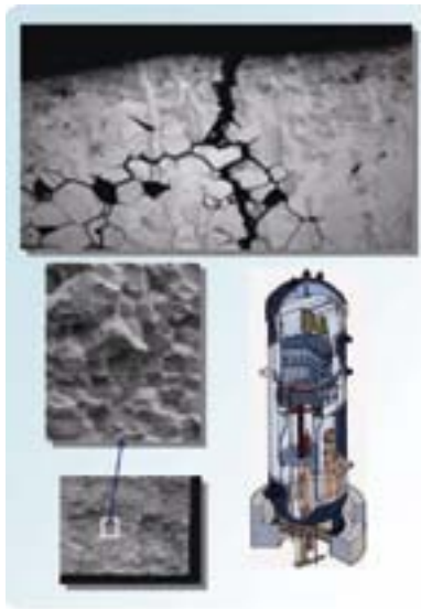
図 1 炉心シュラウドにおける応力腐食割れ（経済産業省 HP より）
