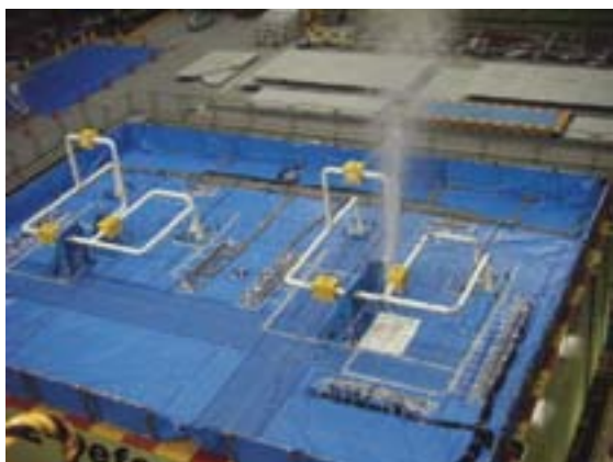
図2 減肉試験体が損傷したときの状況 設計で許容されるレベルの約5.6倍の入力で加振。左側の健全試験体はまだ損傷していません。
