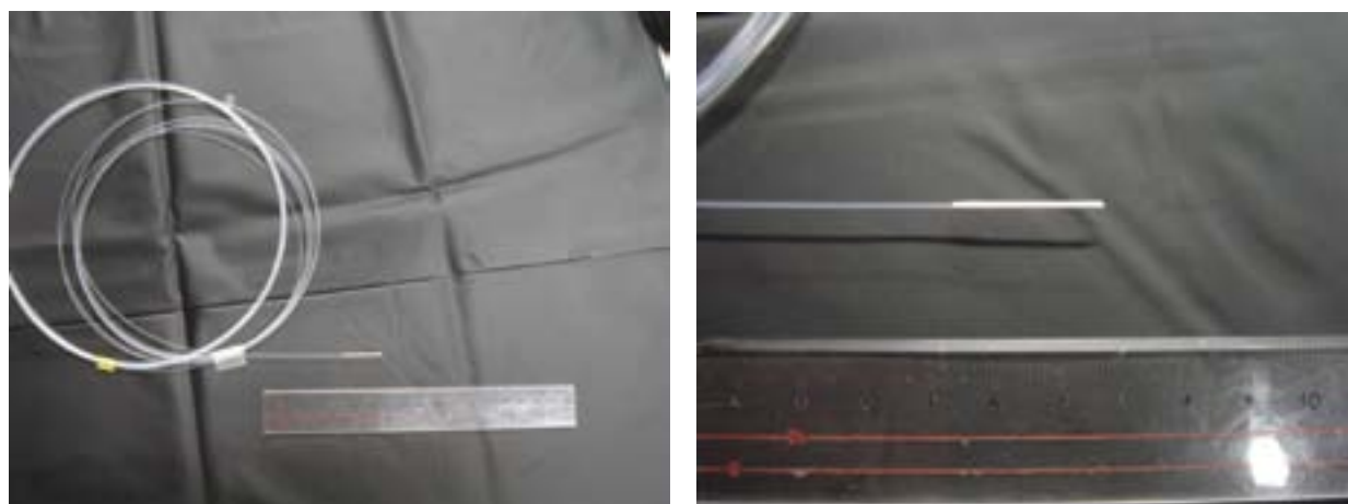
図2 作製したマイクロサイズ線量計の外観写真 光ファイバの外径とほぼ同じ直径のセンサ部を実現（約1mm）。 体内挿入時の患者さんの負担を軽減できます。
