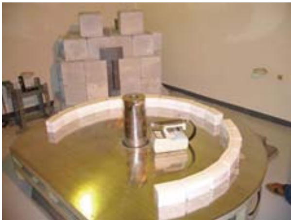
Co 60 γ線研究用照射装置 RE-1082型(1.22 Gy/ min)
