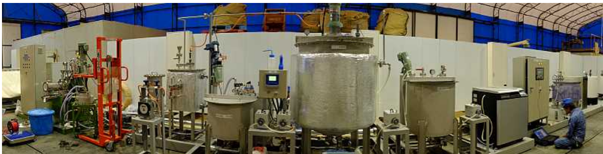
図3. 南相馬市に設置した木質バイオマスメタン発酵パイロットプラント 湿式ミリング前処理→メタン発酵→発酵排水処理のシステムを組みスギ材などの木質バイオマスの減容化・メタン発酵の実証試験を行っております。このパイロットプラントは、平成24~26年度のプロジェクトの30倍規模のものです。現在、木質バイオマスからバイオ燃料を順調に生産できることが示されております。
