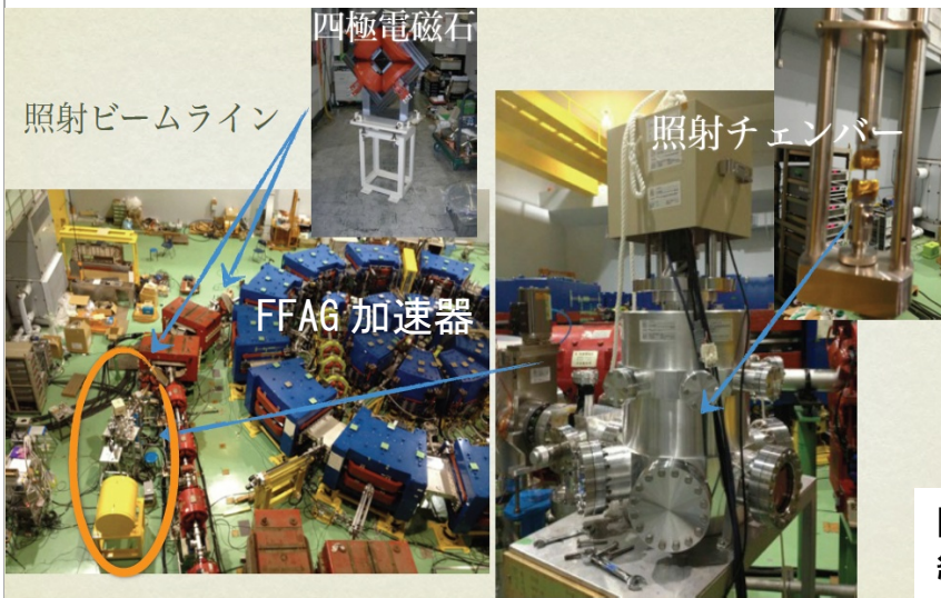
図3 プロトンビームラインと照射チェンバー。
