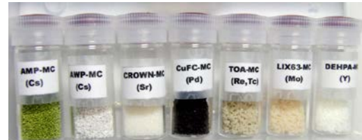
図1 高機能性キセロゲルによる核種の精密分離（左）とマイクロカプセル（右） 高レベル廃液から各マイクロカプセルカラムにより有用元素をクロマト分離します。マイクロカプセルは、様々な無機・有機吸着剤を包み込んで造粒した吸着剤です。
