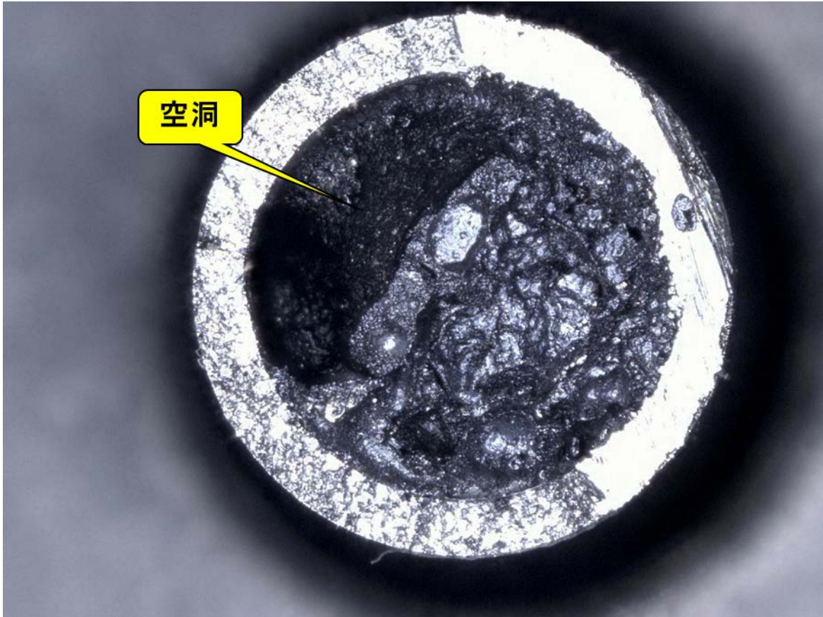
図 3. 4-14 加熱試験後の試料断面図
