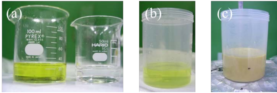
図 3.5-2 混合溶液作製と共沈過程
