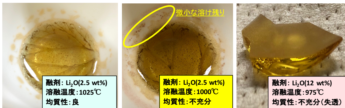
図 3. 1. 1-5 ガラス均質性の評価結果の一例 (H29)
