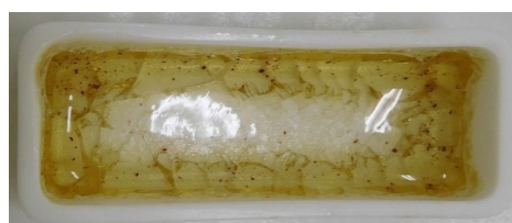
条件No. 3 Na 2 B 4 O 7 30wt%+Na 2 O4.5wt%, 1000°C, 3h
