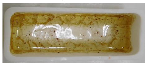
条件No. 2 Na 2 B 4 O 7 30wt%+Na 2 O3wt%, 1000°C, 3h
