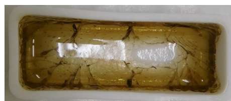
条件No. 5 Na 2 B 4 O 7 30wt%+Na 2 O3wt%, 1150°C, 3h
