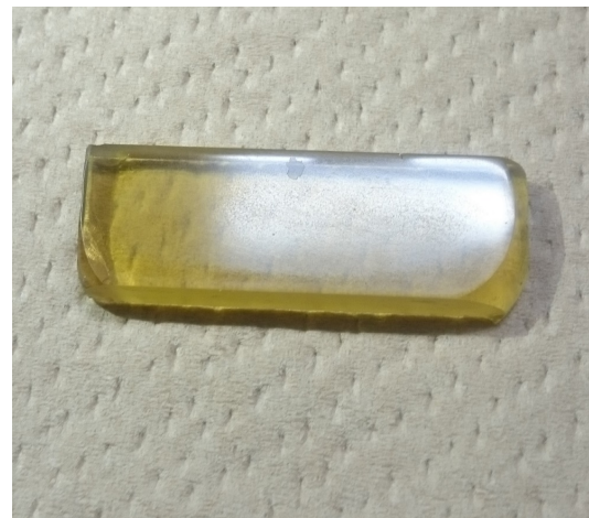
図 3. 1. 1-3 黒鉛製るつぼから取り出したガラス固化体と切断研磨後のガラス固化体
