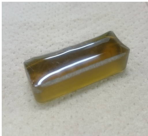
図 3. 1. 1-3 黒鉛製るつぼから取り出したガラス固化体と切断研磨後のガラス固化体
