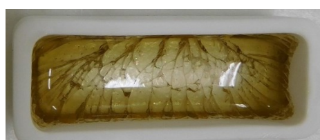
条件No. 6 Na 2 B 4 O 7 30wt%+Na 2 O4.5wt%, 1150°C, 3h
