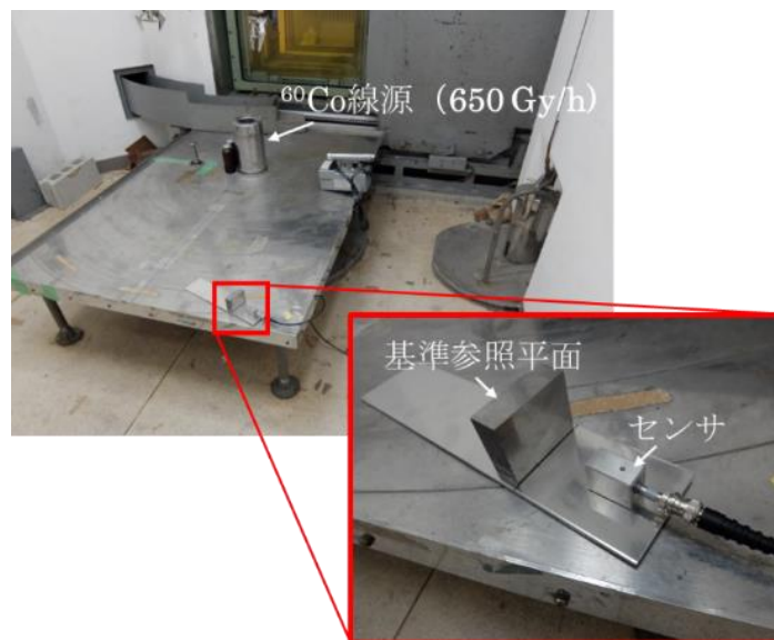
図 3.1-10 Co-60 照射実験の外観
