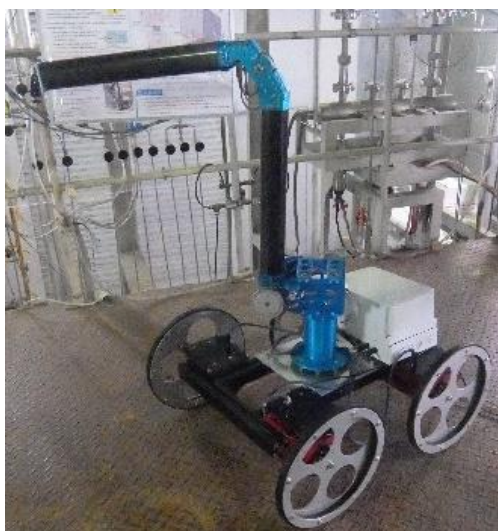
図 3.1-20 搬送用ロボットの試験運転
