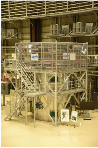
図 3.1-25 JAEA 檜葉の試験用大型水槽 主要寸法：直径 4.5m x 高さ 5.5m（水深 5m） （写真：JAEA 檜葉遠隔技術開発センター提供）
