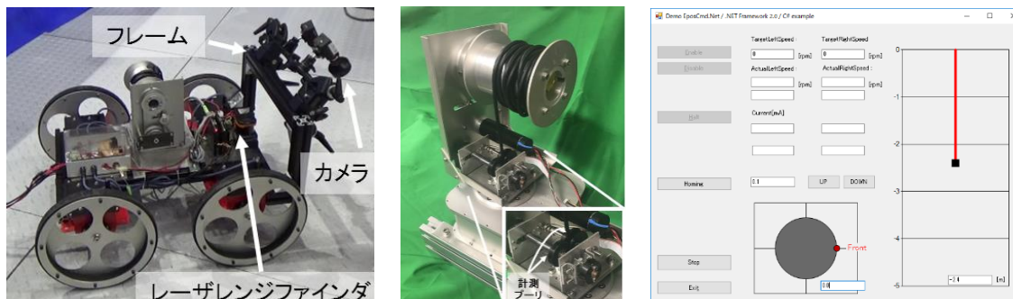
図 3.2-7 ロボットシステムの改良：（左）カメラ固定フレーム、（中）ウィンチ機構と計測プーリ、（右）制御用統合ソフトウェア操作画面（センサ高さと向きを表示可能）
