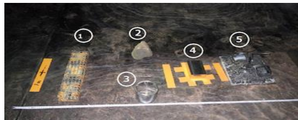
図3.2.1-4 水槽底部に置いた ①粗さブロック、②岩、③SUS円筒、④SUS平滑ブロック及び⑤性状模擬デブリ
