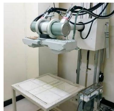
図 6. 放射線発生装置 (PANTAK HF-320)
