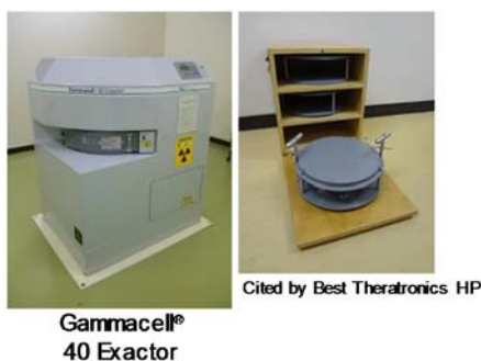
図6. \gamma 線照射装置ガンマセルと鉛製遮蔽体
