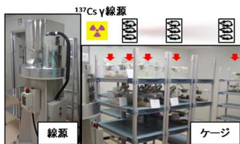
図8. 低線量率γ線照射装置と照射方法
