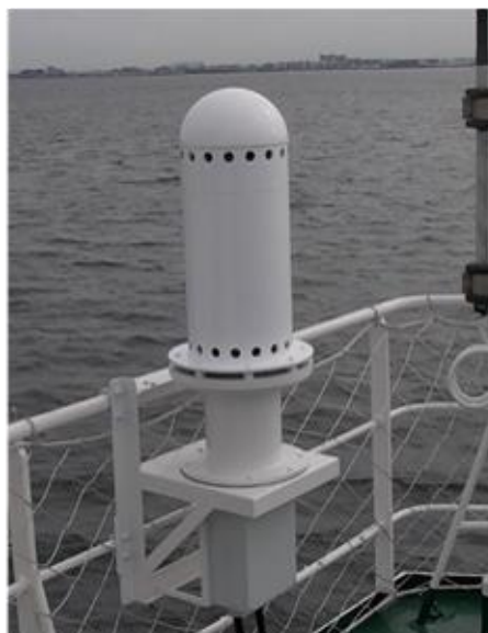
図 3-12 船舶用モニタリングポスト検出部
