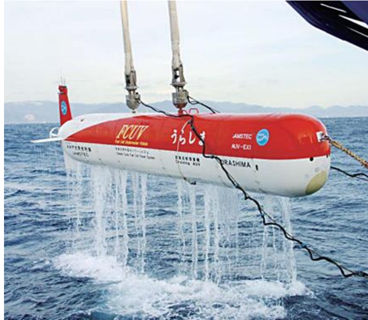
図 3-57 自律型水中航走体 S1(うらしま) (JAMSTEC Web サイトより引用)
