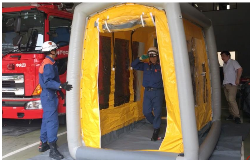
図 3-16 神戸市消防局特殊災害隊所有のランコ式除染テント
