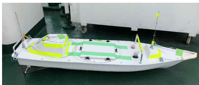
図 3-59 深江丸実験に用いた無線小型ボート外観
