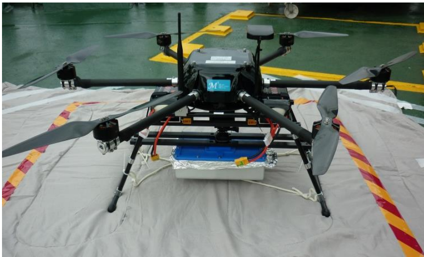
図 3-38 線量モニタリングシステムを取り付けたドローン
