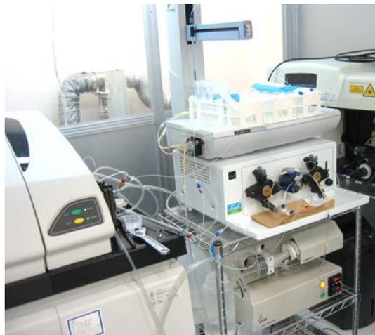
図 3.2-9 Sr-90 定量に用いた ICP 質量分析システム
