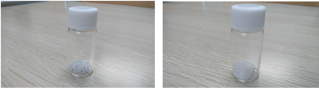
図 3.1.1-1 Ti-Zn 合金由来の造粒体（左）と金属 M（非公開）交換吸着材の造粒体（右）
