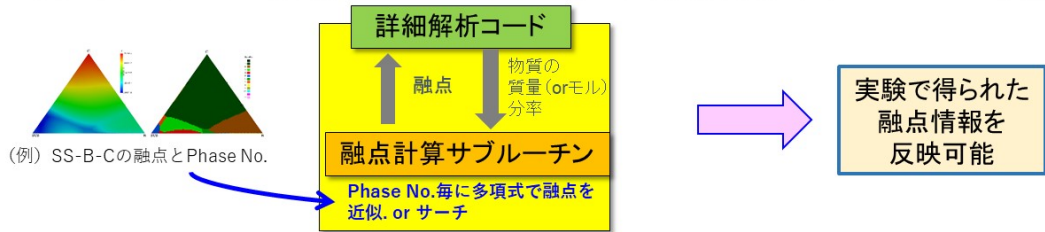
図 3-4-1 JUPITER コードの共晶反応モデル
